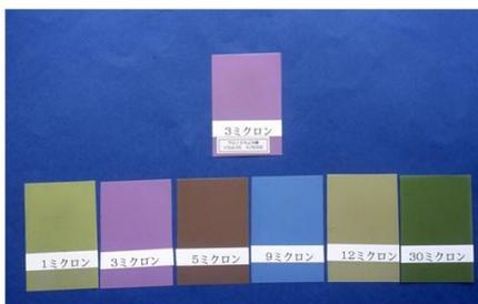
微細粗さ弁別に用いた住友3M製精密研磨紙
